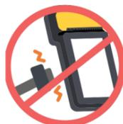
Não force a entrada e retirada do carregador no conector;
